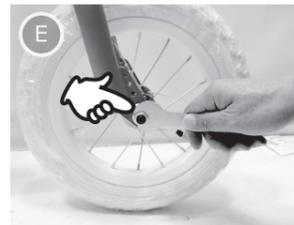
写真Eのように付属工具でナットをしっかりと締めてください。但し、締めすぎるとナットの破損につながる恐れがございますのでご注意ください。
