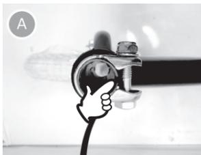
写真Aのようにまずハンドルパークランプとステアチューブの溝の位置を合わせてください。
