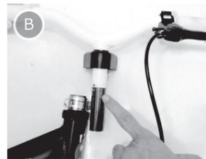
写真Bのようにハンドルバーにある塗装ラインが最低挿入ラインです。このラインが出ない範囲で高さの調整をしてください。
