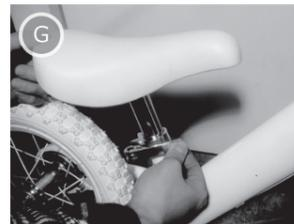
写真Gのようにレバーをしっかりと締めてください。シートをまっすぐに固定し、サドルが動かないか注意し確認してください。ゆるい場合はレバーの逆側を掴み、レバーを回し締め付けてください。
