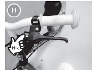
お子様の手が小さくブレーキレバーに届きづらい時はブレーキレバーを近くする調節ネジ(写真H-a)を時計回りに締めていくとレバーが近くなります。お子様が握りやすい位置に合わせてください。ブレーキレバーは4本指若しくは2本指で効くように調整してください。位置調整後にブレーキの引きずりが無い様お確かめください。
