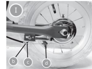
ブレーキの効きが悪くなってきた場合の調整方法は、写真Iのbとcのネジを反時計回りに回して緩めます。ワイヤーが引っ張られて調整の幅がもてます。そしてdのネジを緩めワイヤーを前方向に引っ張りながら調整をします。(ワイヤーの引きすぎにご注意下さい) dのネジを締め直して最後にcのネジを時計回りに締めてロックしてください。
