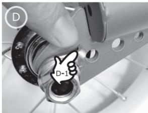
前輪をはめる時に写真Dのようにワッシャーの爪(D-1)を確実にフォークの穴(D-2)に入れてください。
