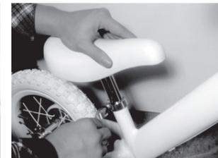
シートポストをフレームに挿し込みます。レバーを緩め、シートポストに最低ラインのマークがあります。(写真F) そのラインが出てこない範囲で高さを調整してください。
